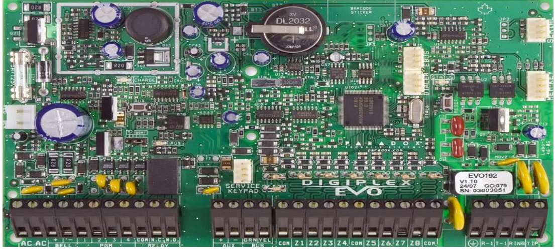
Resim 1.9: Yüz doksan iki zone kontrol paneli
