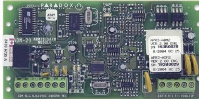
Resim 1.22: Telefon hattı üzerinden kontrol modülü
