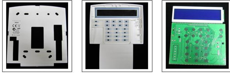
Resim 2.12: Keypadlerin demonte ve monteli görüntüleri
