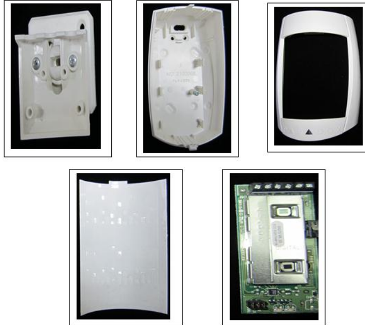
Resim 2.17: Hareket dedektörü bağlantı ayağı ve iç yapısı
