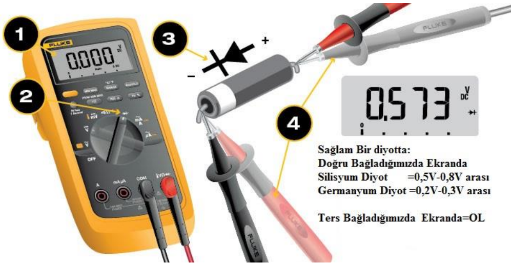
Resim 4.17: Dijital avometre ile diyot sağlamlık kontrolü
