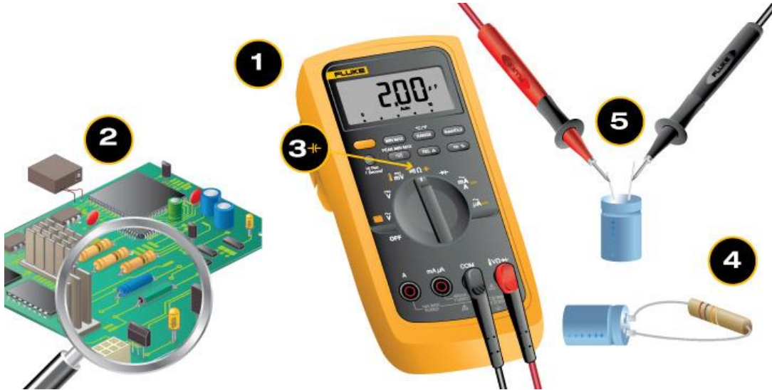
Resim 2.12: Kondansatörün sağamlık kontrolü
