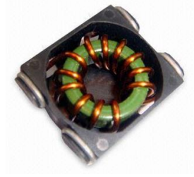
Resim 3.6: SMD Toroid demir nüveli bobin
