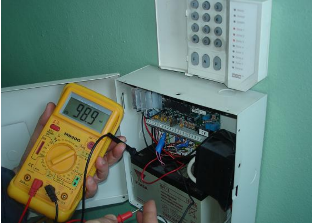
Şekil 1.9: Soygun alarm sisteminde akım ölçmek
