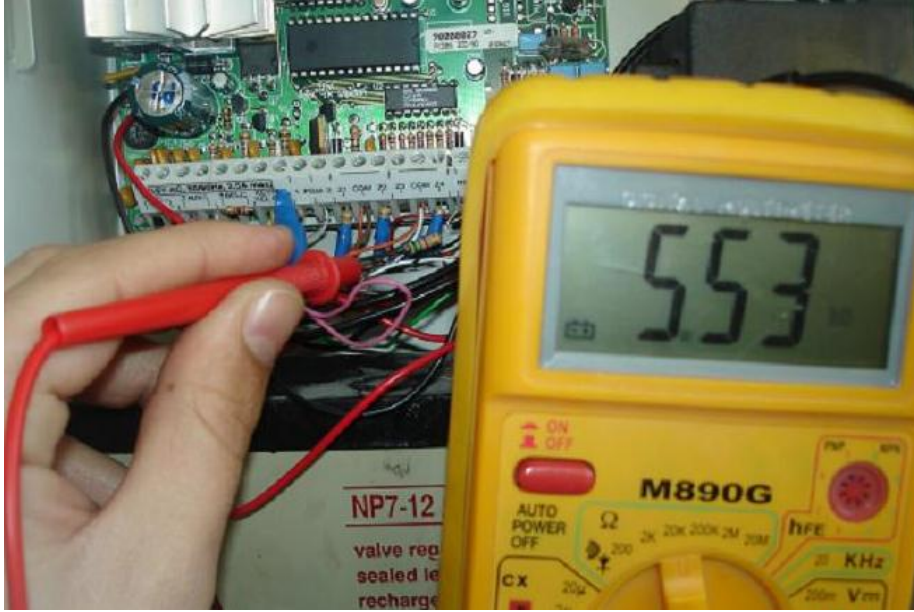
Şekil 1.17a: Soygun alarm sisteminde cihazın topraklama direncini ölçmek
