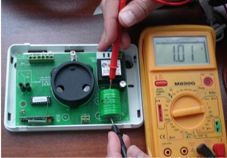
Şekil 1.7: Soygun alarm sisteminde gerilim ölçmek
