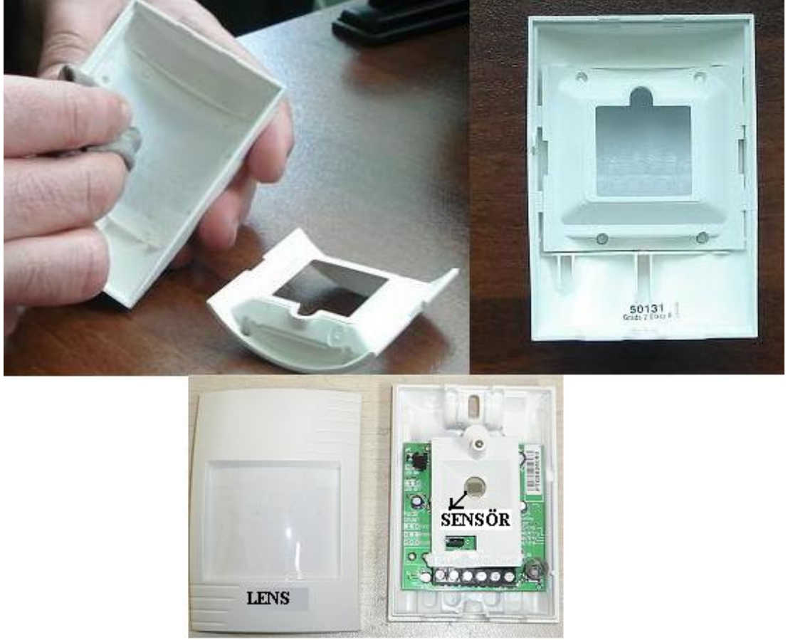
Şekil 3.1: PIR dedektörünün temizlenmesi
