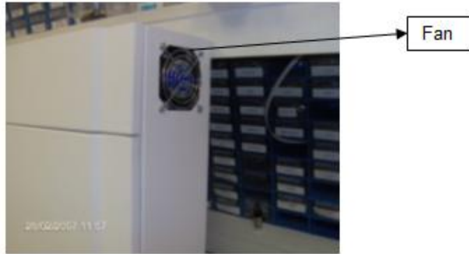
Fotoğraf 2.2: Cihaz içindeki fanın montaj görünüşü
