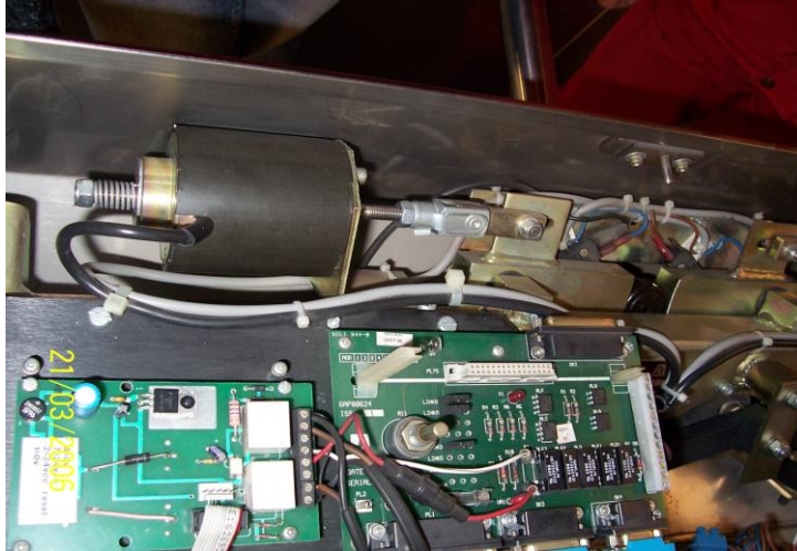
Resim 1.40: Jetonlu turnikenin mekanik aksamı
