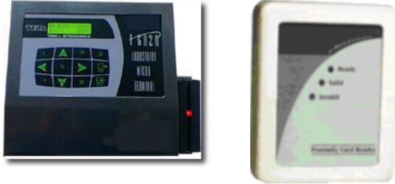
Resim 3.15: En çok tercih edilen kart okuyucu tipi
