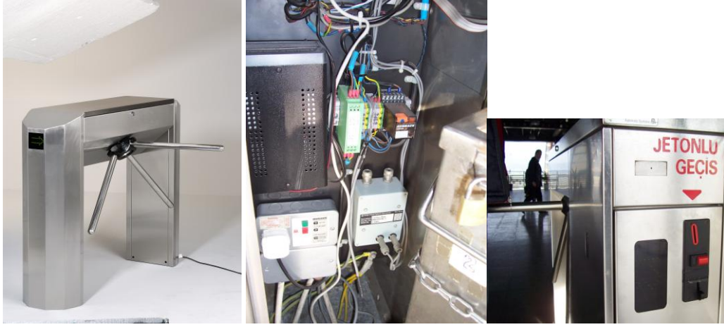
Resim 1.39: Jetonlu turnikeler ve iç yapısı
