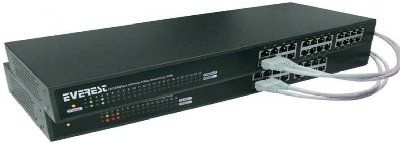
Resim 2.26: Dağıtıcı UTP kablo bağlantısı
