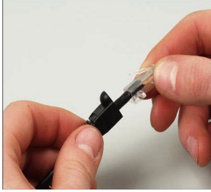
Resim 2.24: Yalıtkan kapağın takılması
