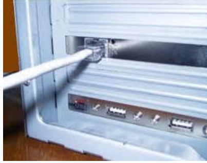
Resim 2.27: Bilgisayar kasası UTP kablo bağlantısı
