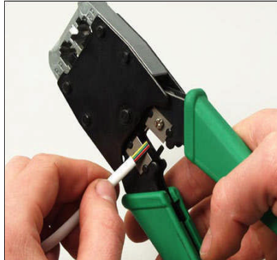
Resim 2.29: İletken tellerin kesilmesi
