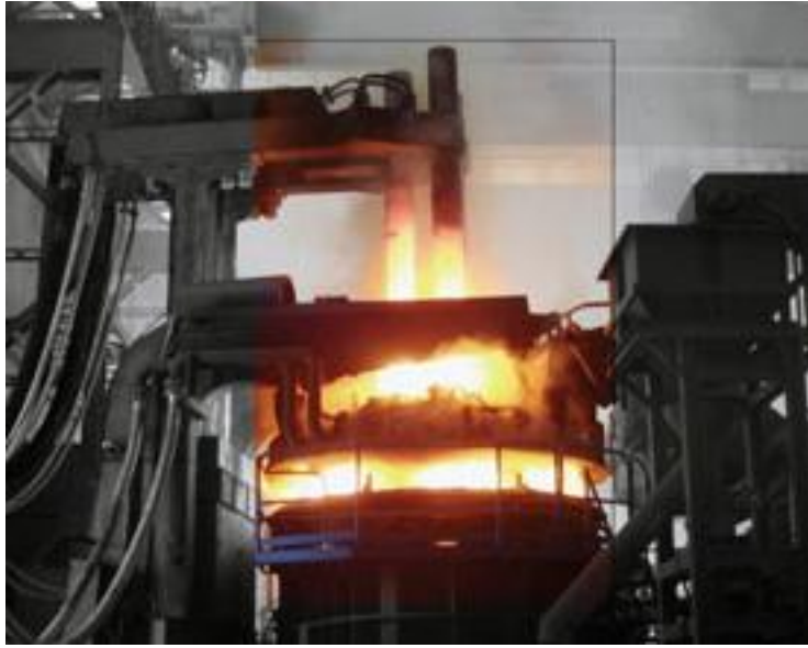
Resim 1.3: Bir ark fırınında ergitme işlemi
