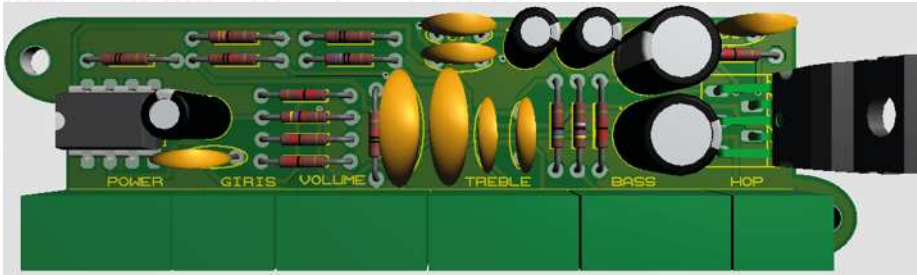
Plaketin boş yerlerinin bakır kaplanması (üstten 3D)
