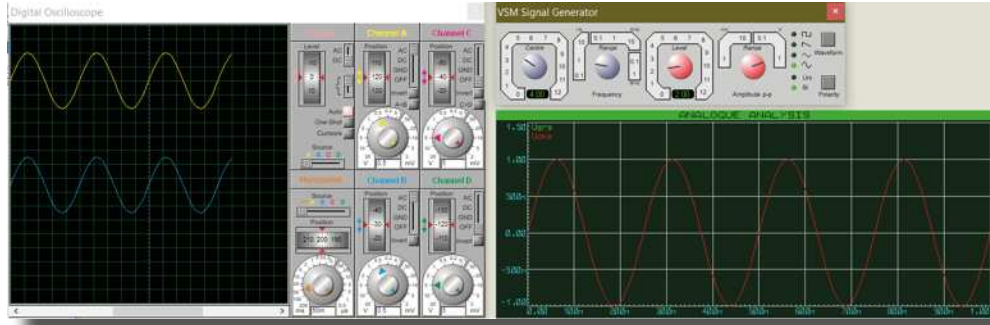
(f) Gerilim izleyici devresinin osiloskop ve grafik analogue ile sinyal ölçülmesi
