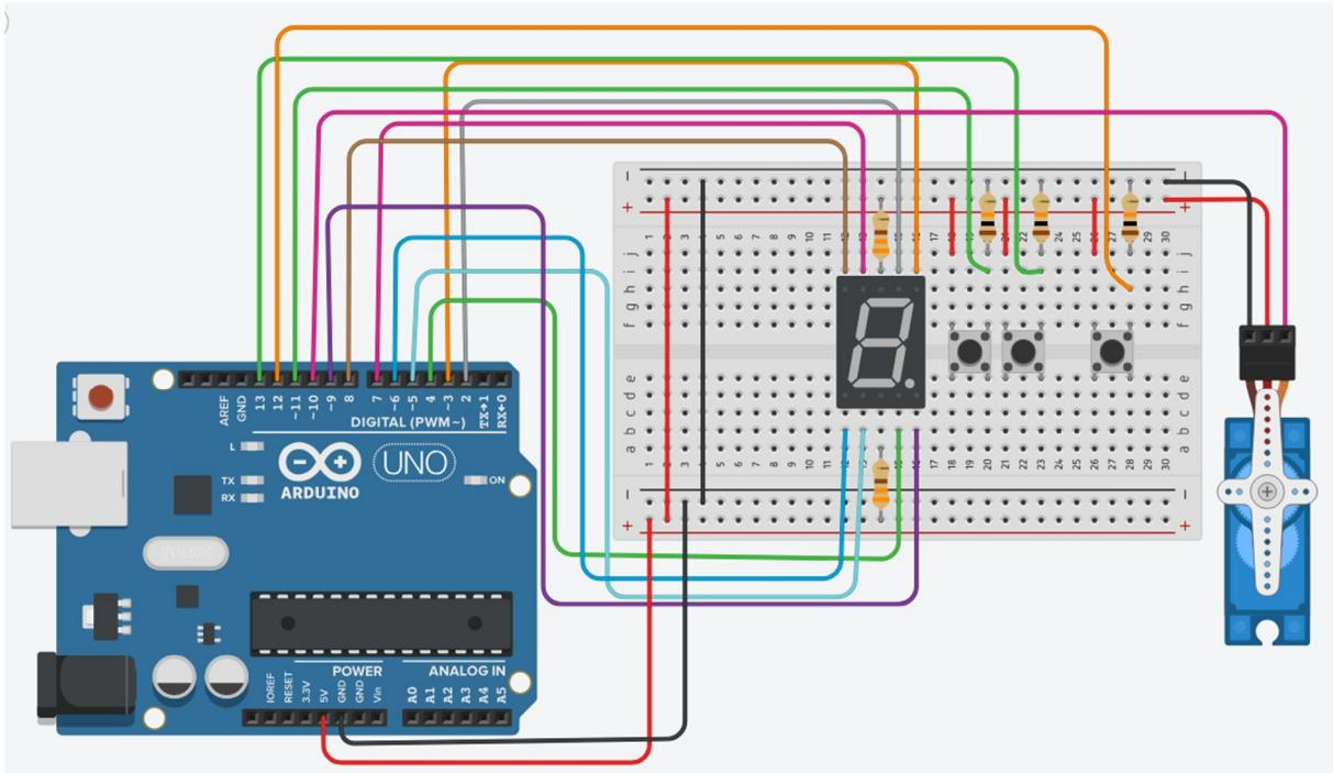
İçeride bulunan araç sayısını segment display ile görebileceğimiz ve buton ile giriş çıkış yapabileceğimiz bir otopark sistemi sizlerle . Detaylar videomuzda...
