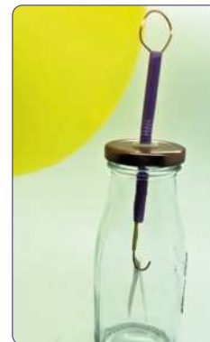
Görsel 1.91: Elektroskop ile yük ölçümü
