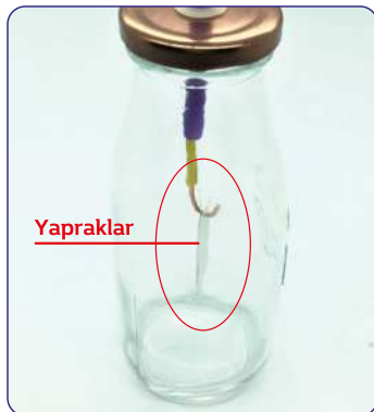
Görsel 1.90: Montajı bitmiş elektroskop
