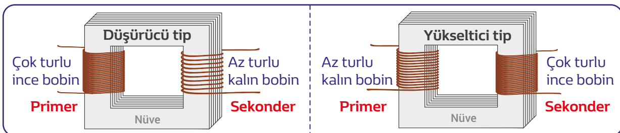
Görsel 3.111: Düşürücü ve yükseltici tip transformatörler
