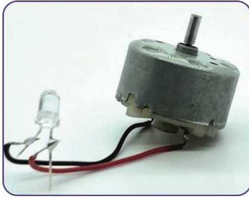
Görsel 1.20: Motor uçlarına LED'in lehimlenmesi
