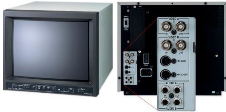
Resim 2.5: Güvenlik kamera bağlantı portları
