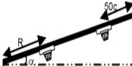
Şekil 2.25: Eğimli tavanlarda duvarla arasındaki mesafe
