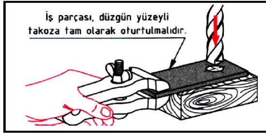
Şekil 4.11: Takoz Üzerinde Serbest Delme
