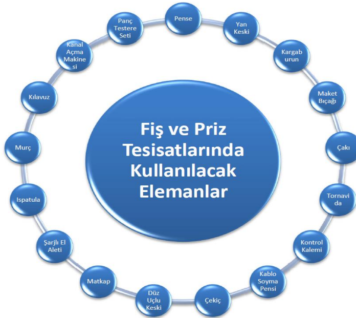
Şekil 2.1: Fiş ve priz tesisatlarında kullanılacak elemanlar
