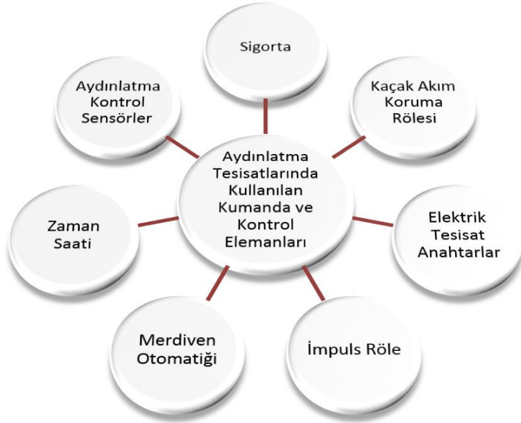
Şekil 1.8: Aydınlatma tesisatlarında kullanılan kumanda ve kontrol elemanları
