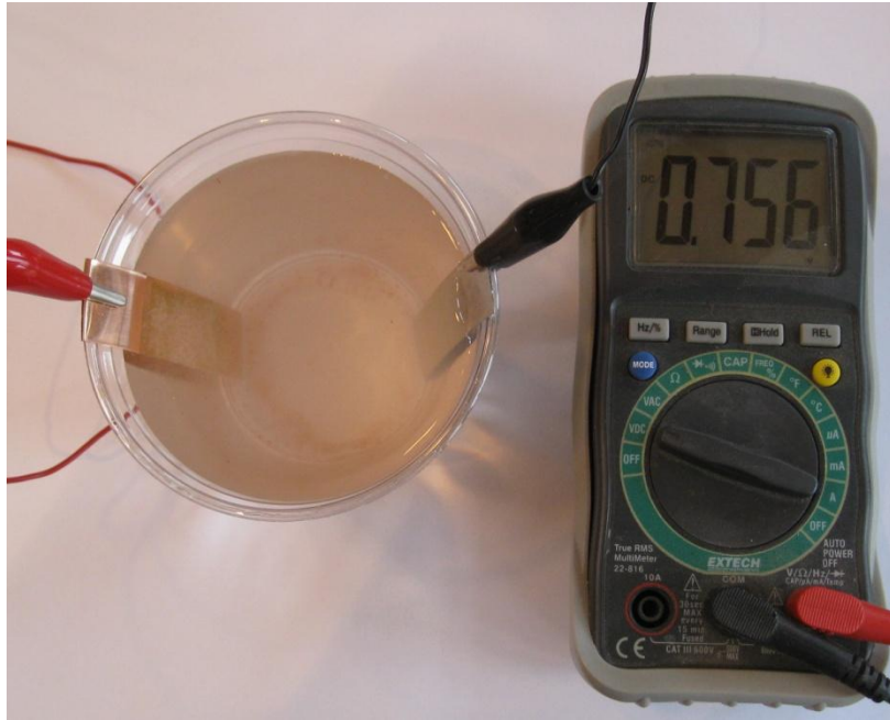
Resim 25: Tuzlu su, bakır ve alüminyum pili
