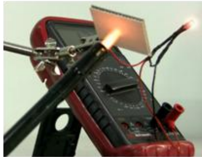
Resim 30: Bir termopil uygulaması
