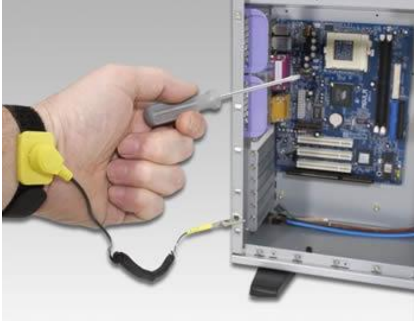
Resim 11: Antistatik bileklikle çalışma
