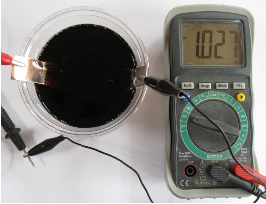
Resim 24: Kola, bakır ve çinko pili
