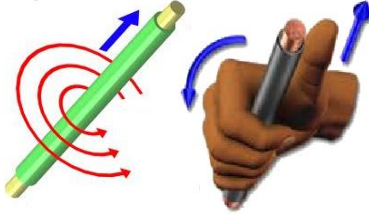
Şekil 66: İletken etrafında oluşan manyetik alan ve sağ el kuralı
