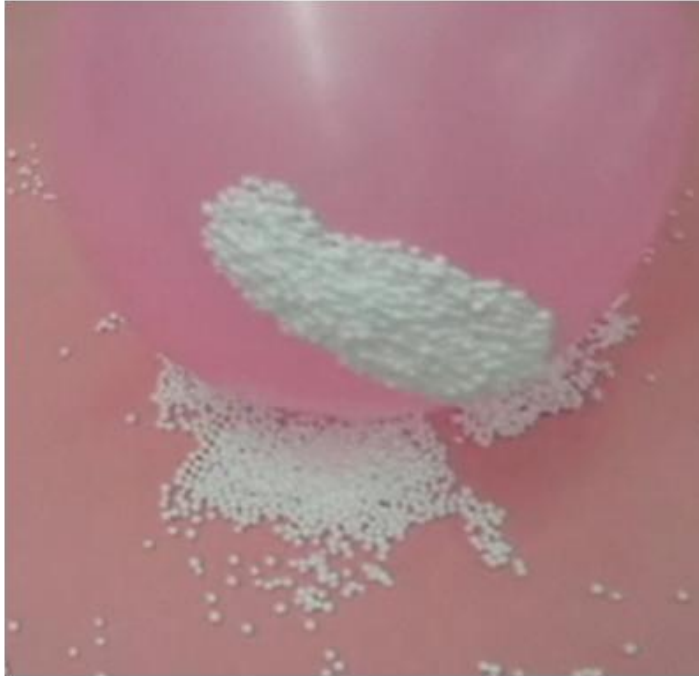
Resim 5: Statik elektrikle yüklenmiş balon
