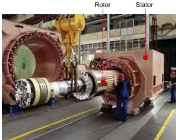
Resim 1: Bir alternatörün statoru ve rotoru
