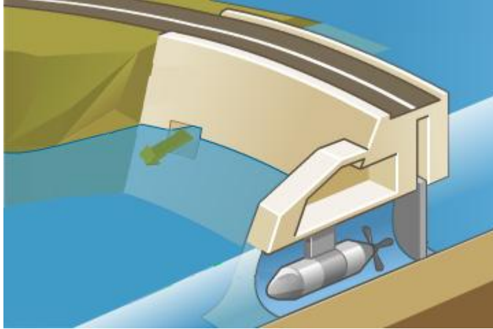
Şekil 9: Gelgit barajı doluyor
