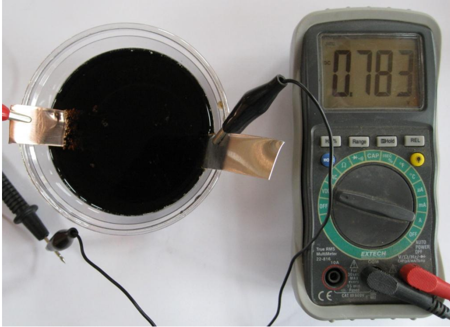
Resim 23: Kola, bakır ve alüminyum pili
