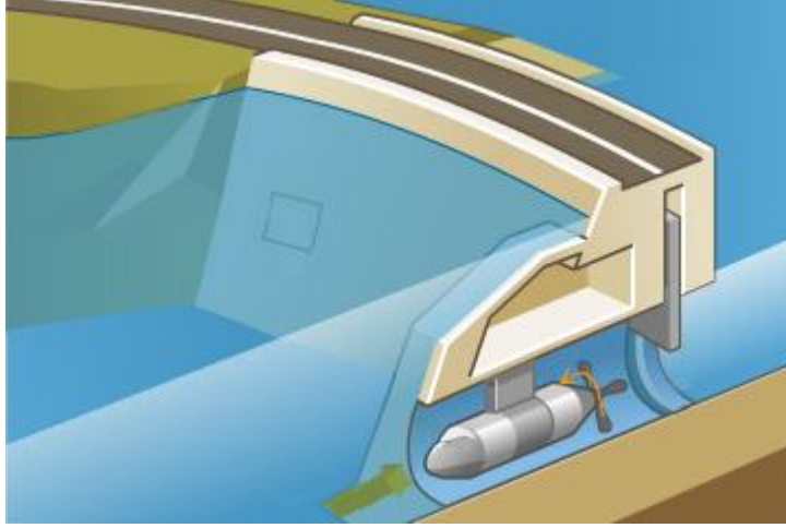
Şekil 10: Gel git barajı boşalırken türbin dönüyor
