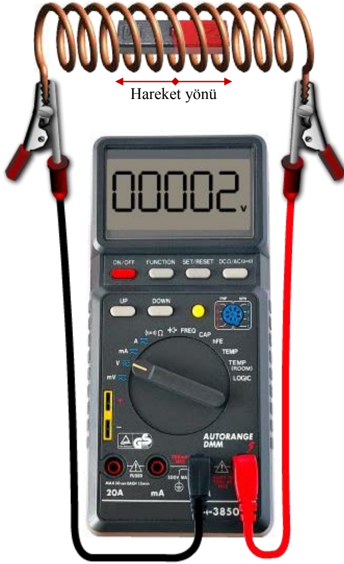
Resim 26: Bir bobinde oluşan gerilim (emk)
