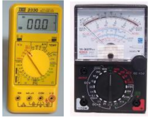
Resim 7.1: Analog ve dijital avometreler
