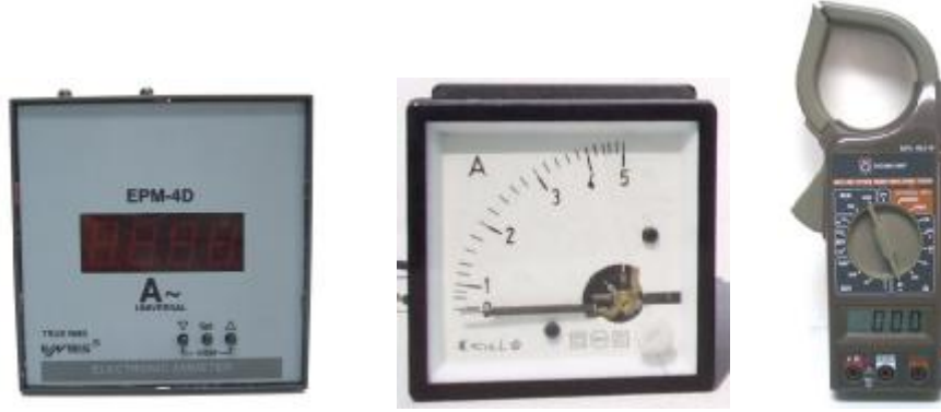
Resim 5.1: a-Dijital pano tipi ampermetre b-Analog ampermetre c- Pens ampermetre
