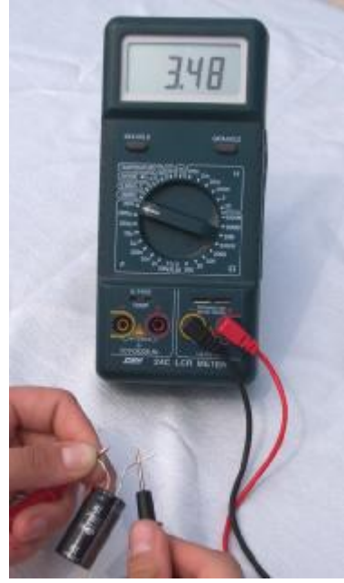
Resim 4.1: Avometre ve Lcrmetre ile kapasite ölçümü
