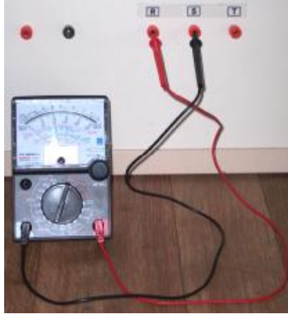
Resim 7.2: Analog avometre ile gerilim ölçme
