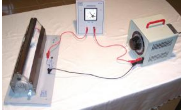
Resim 5.3: Ampermetre ile alıcı akımını ölçmek
