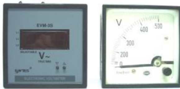
Resim 6.1: a-Dijital pano tipi voltmetre
