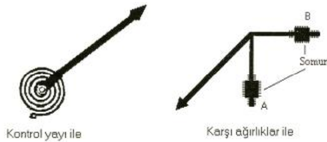
Şekil 1.1: Kontrol yayı ve karşı ağırlıkla kontrol kuvveti
