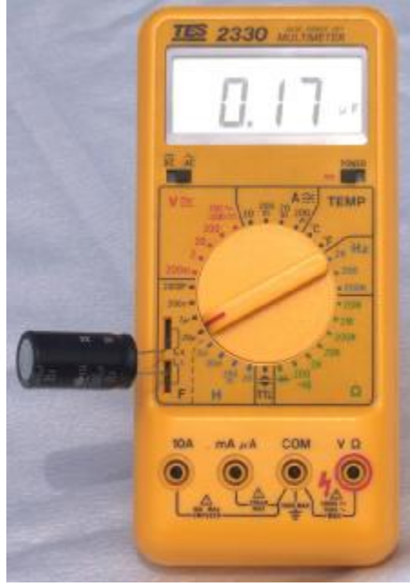
Resim 4.1: Avometre ve Lcrmetre ile kapasite ölçümü
