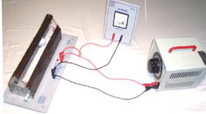
Resim 6.2: Voltmetrenin devreye bağlanması
