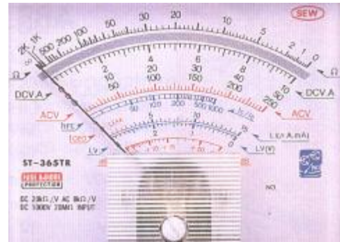
b- Analog avometre skalası
