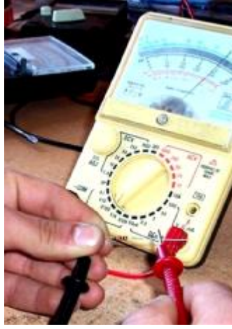
Resim 2.1: Avometre ile direnç ölçümü
