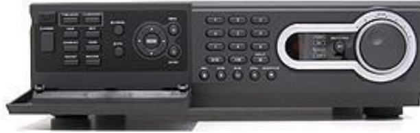
Resim1.5: Çoklayıcı (Multiplexer) ön görünüş
