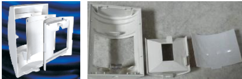
Şekil 1. 57: Bir pir detektörün demonte şekilde lensi
